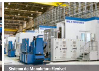
Sistema de Manufatura Flexível
