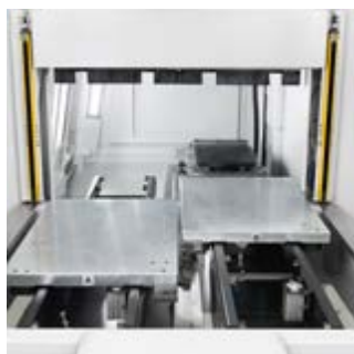
Movimentação servoacionada dos pallets
