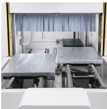
Movimentação servoacionada dos pallets
