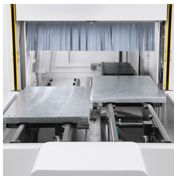
Manipulación de pallets con servomotores
