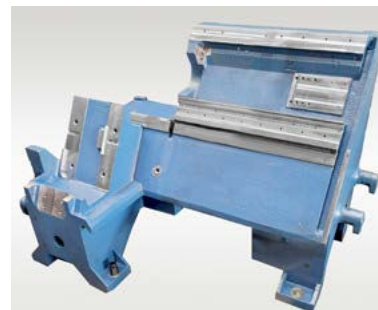
Estructura monobloque de hierro fundido de alta calidad
