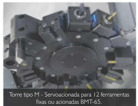
Torre tipo M - Servoacionada para 12 ferramentas fixas ou acionadas BMT-65.
