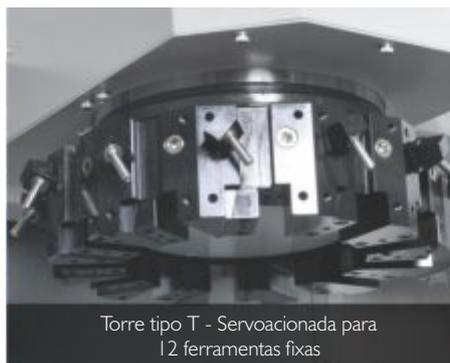
Torre tipo T - Servoacionada para 12 ferramentas fixas
