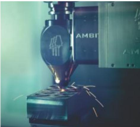
Processo de deposição de material no Centro de Usinagem ROMI D 800 HYBRID
