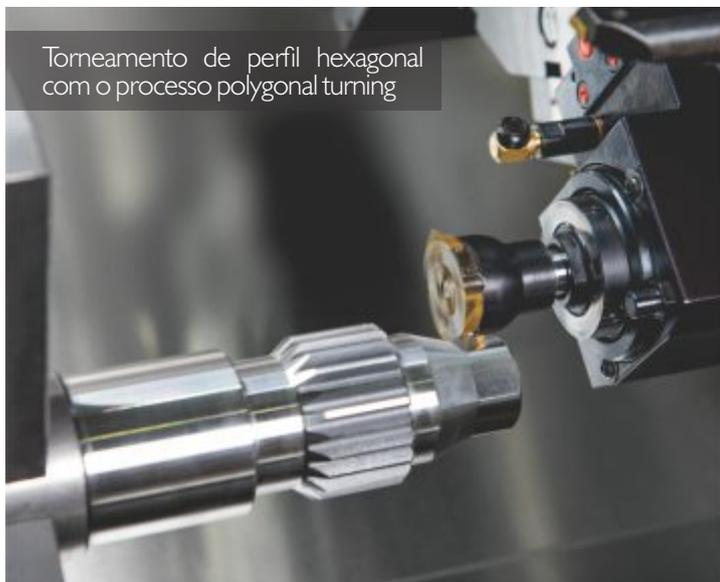
Torneamento com suporte de ferramentas duplo e eixo Y
