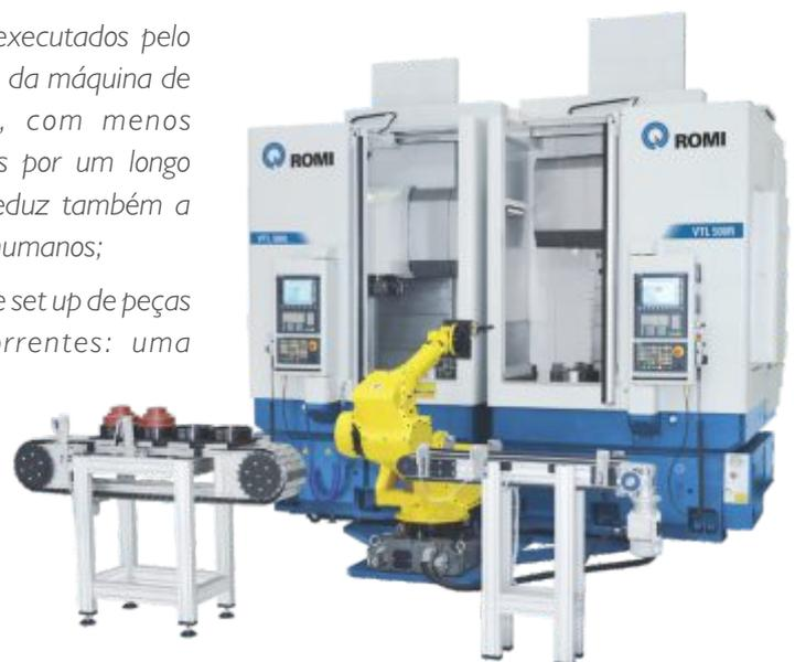
reduzindo drasticamente o tempo de carga e descarga do equipamento. A peça pronta é colocada em local de fácil acesso de retirada pelo operador.
