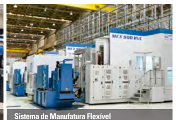
Sistema de Manufatura Flexível
