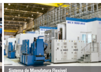
Sistema de Manufatura Flexível
