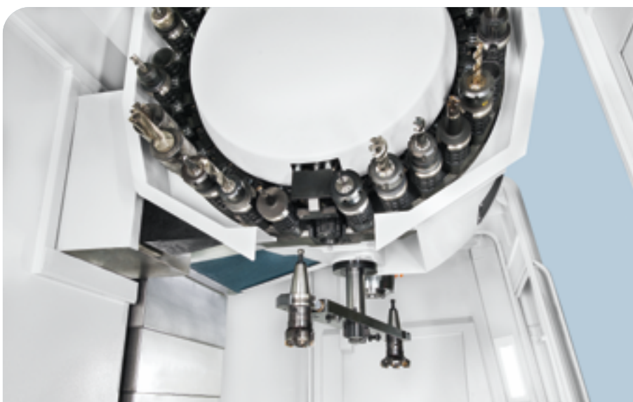
Cambiador automático de herramientas con capacidad para 30 herramientas (ROMI D 800 / D 1000 / D 1250)
