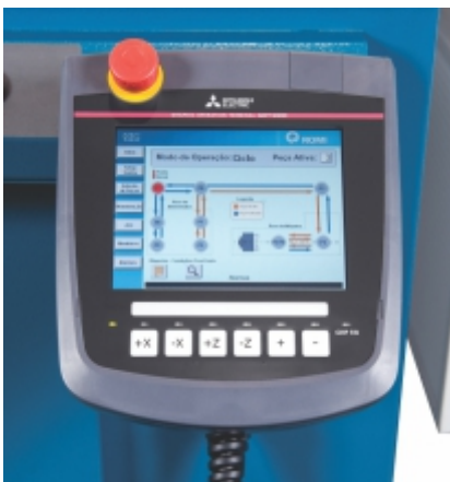
Painel de operação remoto
