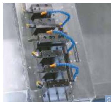
Sistema Gang Tools para suportes porta-ferramentas: inclinação de 60°, facilidade de acesso do operador aos suportes de ferramentas e escoamento de cavacos
