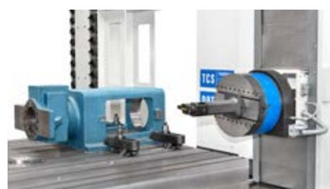
Opcional Cabeçote D'Andrea U-TRONIC com flange de adaptação para faceamento externo, interno e angular, roscas e mandrilhamento de perfis planos, cilíndricos, cônicos e raiados automaticamente, através do programa CNC.
