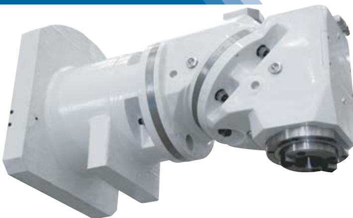
A ROMI Lazzati HBM 130T pode ser equipada com Cabeçote Manual universal (opcional). Possui engrenagens cônicas de precisão, que garantem a rotação da ferramenta com excelente performance. Permite o posicionamento do mandril em qualquer ângulo, e conta com pinos posicionadores para os ângulos de 0°, 90°, 180° e 270°.
