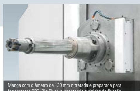
Manga com diâmetro de 130 mm nitretada e preparada para ferramentas BBT (Big Plus), aumentando a rigidez de fixação.
