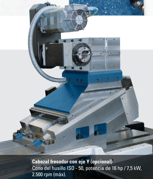
Cabezal fresador (opcional) Cono del husillo ISO - 50, potencia de 10 hp (7,5 kW), 2.500 rpm (máx).
