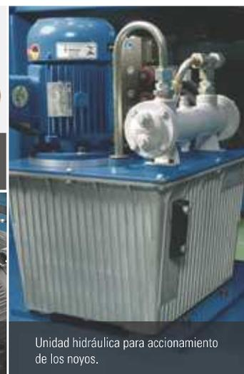
Unidad hidráulica para accionamiento de los ejes.
