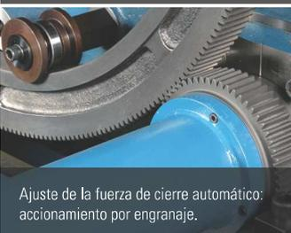
Ajuste de la fuerza de cierre automático: accionamiento por engranaje.
