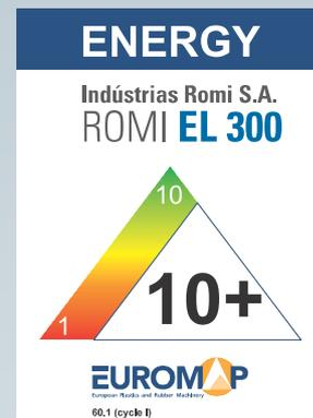
Classificación de energía conforme EUROMAP 60.1 (cycle I); "+" representa el consumo de energía inferior a 1KWh para mantener la temperatura de calefacción en modo espera.
