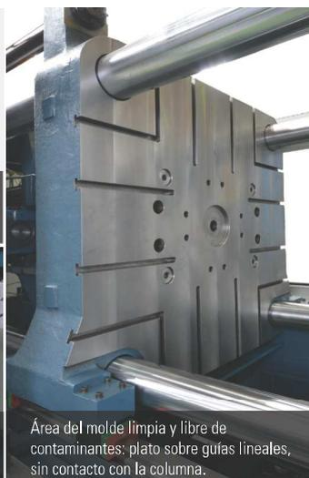
Área del molde limpia y libre de contaminantes: plato sobre guías lineales, sin contacto con la columna.
