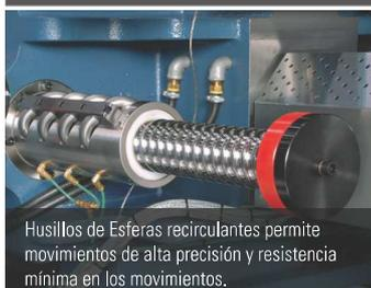
Husillos de Esferas recirculantes permite movimientos de alta precisión y resistencia mínima en los movimientos.
