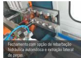
Fechamento com opção de rebarbação hidráulica automática e extração lateral de peças.
