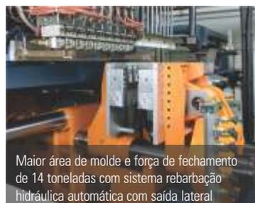
Maior área de molde e força de fechamento de 14 toneladas com sistema rebarbação hidráulica automática com saída lateral
