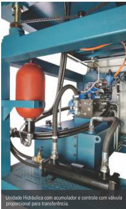
Unidade Hidráulica com acumulador e controle com válvula proporcional para transferência.
