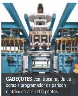
**CABEÇOTES** com troca rápida de cores e programador de parison elétrico de até 1000 pontos
