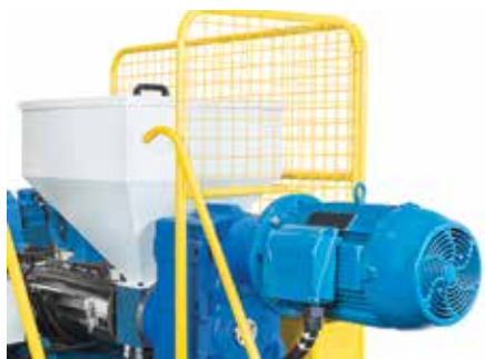
Motor e redutor acoplados diretamente na extrusora: maior desempenho e economia de energia.
