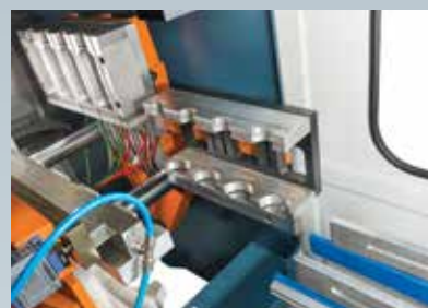
Fechamento com opção de rebarbação hidráulica automática e extração lateral de peças.
