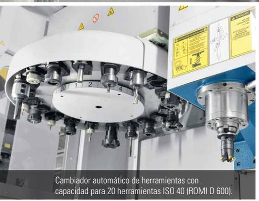
Cambiador automático de herramientas con capacidad para 20 herramientas ISO 40 (ROMI D 600).
