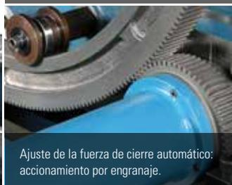
Ajuste de la fuerza de cierre automático: accionamiento por engranaje.
